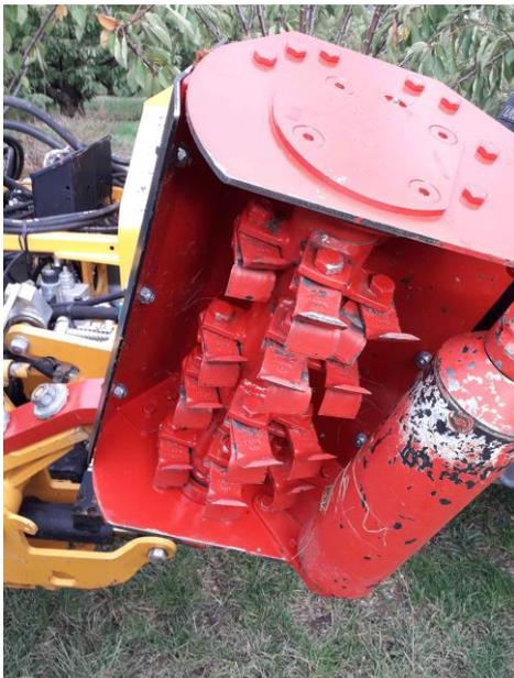
**Avantages :** nécessite peu de puissance, efficace dans de l'herbe développée, bonne maniabilité de l'ensemble, pas de cardan.
