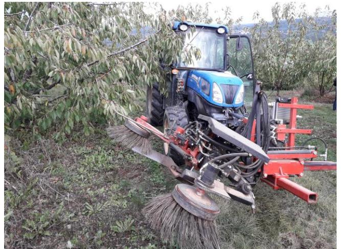
**Avantages :** pas de cardan, effacement sans contact avec le tronc, pas de projection, largeur de travail de plus d'un mètre, durée de vie des brosses, bon travail en condition caillouteuse, débit de chantier élevé.
