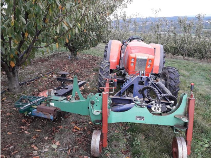
Porte outil avant équipé d'une houe rotative ALM et d'un doigt KRESS
