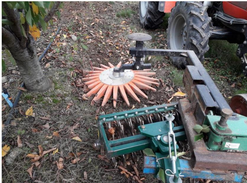
**Avantages :** pas de cardan, pas de projection de terre, largeur de travail modulable selon les besoin (largeur de 30 cm à 1 mètre) débit de chantier élevé.
