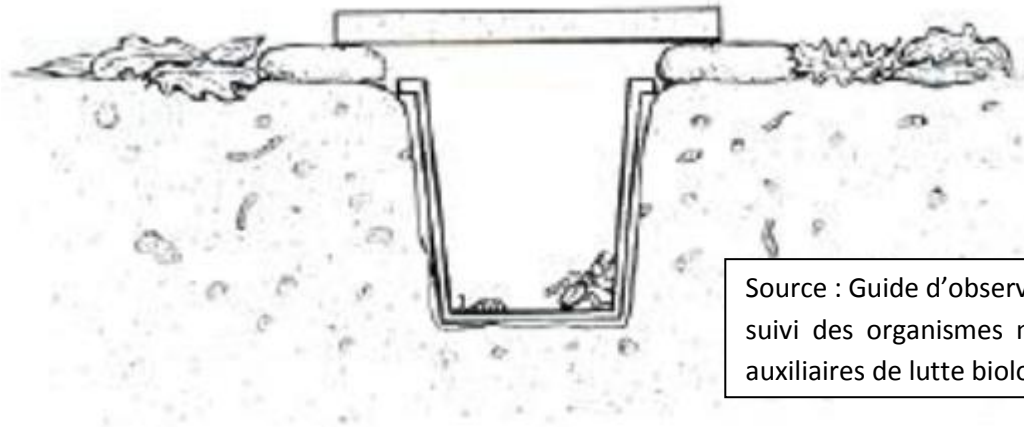
Figure 11 : schéma de mise en place d'un piège Barber
