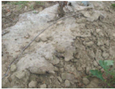
Feutre : dégradation du matériau.
